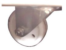
为便于移动, 仪器底部安装脚轮, 位置固定后用 U 形环固定试验机位置。
