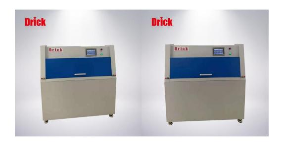
WJ-UV-300 紫外耐气候老化试验箱,采用进口 UVA-340 荧光紫外灯为光源,可以模拟由阳光、雨水和露水造成之危害。UV 耐候箱利用荧光紫外线灯模拟阳光照射之效果,利用冷凝湿气模拟露水。被测试材料放置于一定温度下的光照和潮气交替的循环程序中进行测试,对材料进行加速耐候性试验,以获得材料耐候性的结果。UV 箱用数天或数周的时间即可重现户外数月或数年出现的危害。危害类型包括: 褪色、变色、失光、粉光、开裂、浑浊、气泡、脆变、强度、衰退和氧化等。本机含喷淋装置。
